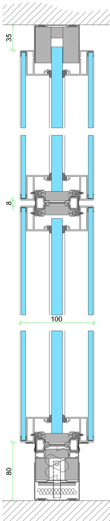
Vertikalschnitt T36 EI30
