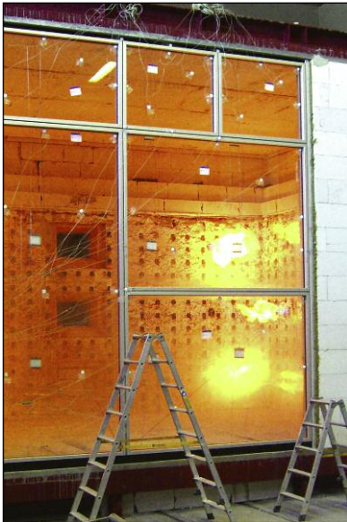
Die Glastrennwand T46, hier im Prüfaufbau. Größte Scheibenabmessung senkrecht 3.000 x 1.500 mm, waagrecht 2.500 x 1.500 mm im Raster.
