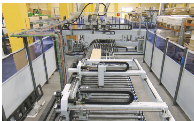
Das Bohren, Dübeleintreiben und Fräsen erfolgt an mehreren Teilstationen
