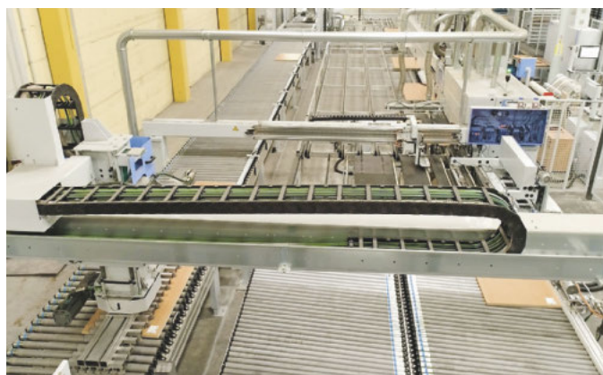
Die Bekantungszelle, links die Rückführung bzw. der Bypass
